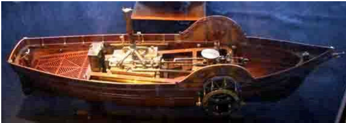
Figure 10: Modelo de barco de vapor construido en 1784 por Claude de Jouffroy. El modelo no incluye la caldera de vapor. Reproducido de Wikipedia
