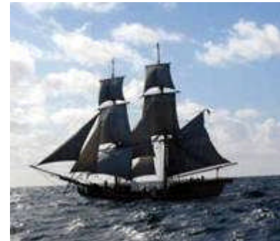
Figura 4: Así luciría el Vesta . Nótese los dos mástiles y las velas cuadradas en ambos.
